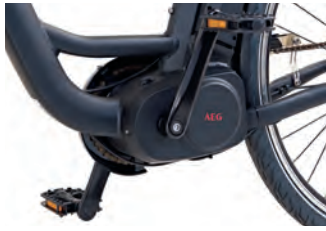
AEG Comfort Drive C: Antrieb mit max. 100 Nm Drehmoment.
