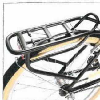
Der Träger ist mit dem Hinterbau verschweißt und sehr steif.
