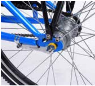
Frontlicht mit Automatikfunktion, griffiges Reifenprofil. Unten: 3-Gang-Nabe: gekapselt, robust, kein Schaltarm, der absteht.
