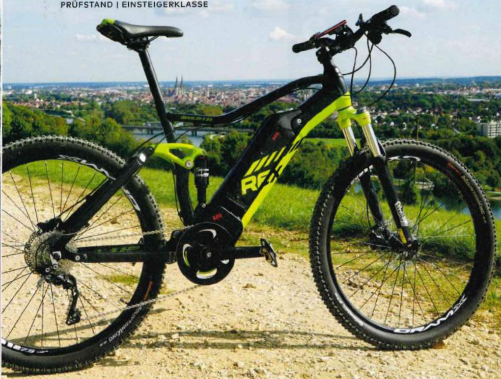
HINTERBAU-SCHWINGE: Der einstellbare Suntour-Luft-Dämpfer steuert die Hinterbau-Auslenkung.
