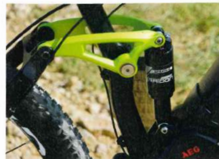
HINTERBAU-SCHWINGE: Der einstellbare Suntour-Luft-Dämpfer steuert die Hinterbau-Auslenkung.
